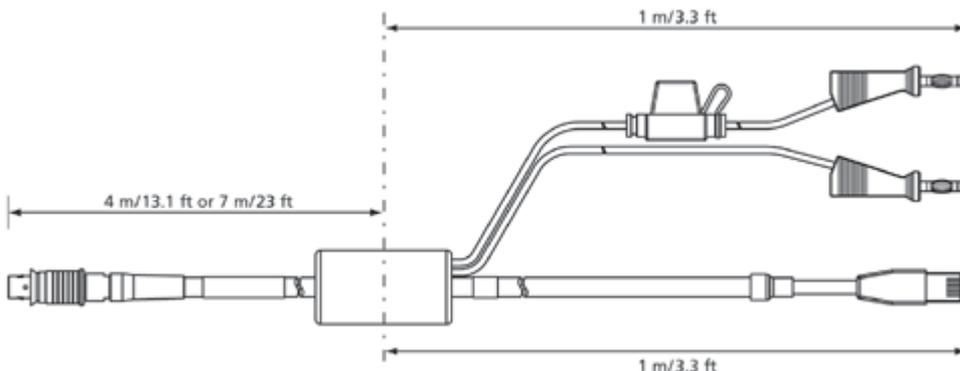
Ethernet-PC-Verbindungs- und Stromversorgungskabel, Stromeinspeisung in der Nähe des PCs, Lemo 1B FGL – RJ45 – Sicherheitsbananenstecker (8fc-8mc+2mc), 5 m      CBEP4155.1-5      F-00K-110-027
