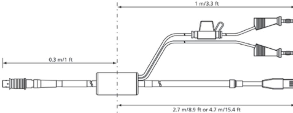
Ethernet-PC-Verbindungs- und Stromversorgungskabel, Lemo 1B FGL – RJ45 – Sicherheitsbananenstecker (8fc-8mc+2mc), 3 m      CBEP4105.1-3      F-00K-110-026
