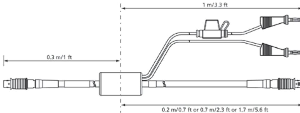
Ethernet-Verbindungs- und Stromversorgungskabel für Modulketten, Lemo 1B FGL – Lemo 1B FGA – Sicherheitsbananenstecker (8fc-8mc+2mc)
