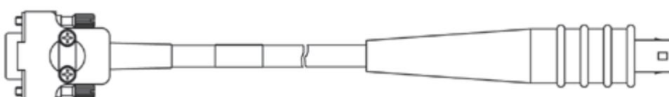
Câble d'interface CAN, DSUB – DSUB (9fc-9mc),
