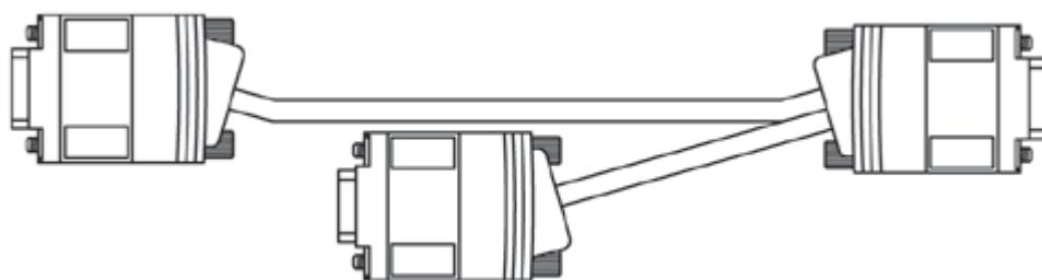
Câble adaptateur pour calculateur CAN, SUB-D
