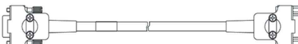
Câble d'interface CAN, OBDII J1962 - Lemo 1B
