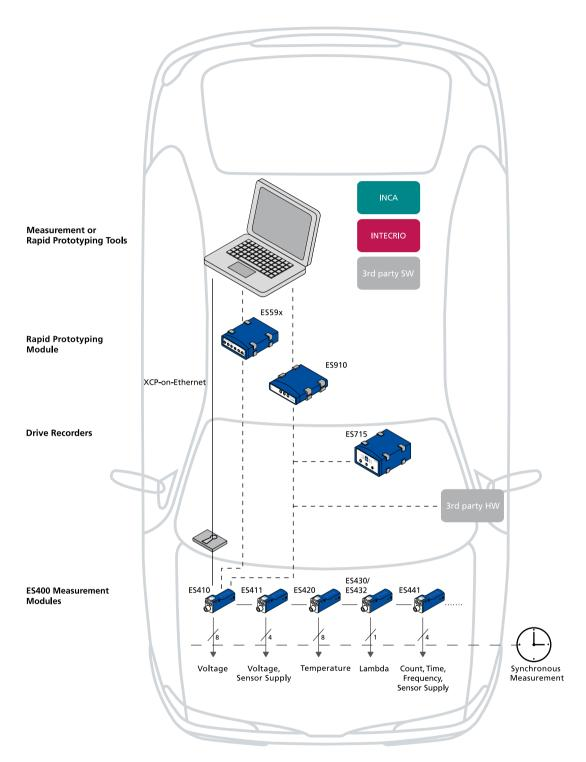
Abb. 3: Im Motorraum montierte ES400-Module werden über eine kleine Öffnung mit dem PC im Fahrzeuginneren verbunden. Statt die Messdaten an einen PC zu übertragen, auf dem die INCA-Messung, das INTECRIO-Rapid-Prototyping oder eine Drittanbieteranwendung ausgeführt werden, können sie auch an ein Rapid-Prototyping-Modul ES910 oder einen ES720-Drive-Recorder übermittelt werden. XCP-on-Ethernet ermöglicht die einfache Verwendung mit Softwaretools und Hardwaregeräten von Drittanbietern.
