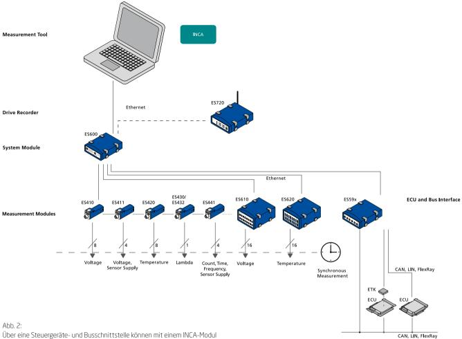
Über eine Steuergeräte- und Busschnittstelle können mit einem INCA-Modul oder ES720-Drive-Recorder parallel zur Übertragung von Sensormessdaten auch Signale vom Fahrzeugbus erfasst und elektronische Steuergeräte (ECU) kalibriert werden. Das ES600-Netzwerkmodul dient als Plattform für die Synchronisierung von ES400- und ES600-Modulen, wobei ein gemeinsamer Synchronisierungsmechanismus zum Einsatz kommt.
